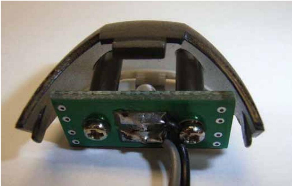
Schieben Sie das Visier mit der LED Platine von vorne in das Kopf Vorderteil HR1C-0004 (131004), bis die Haltehaken im Kopf einrasten.
