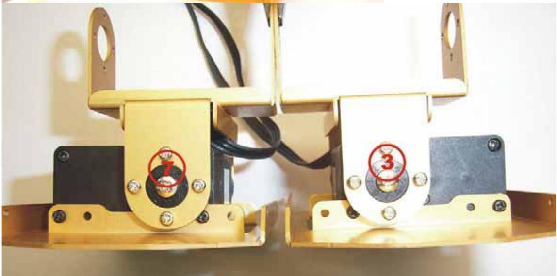
Zum Schluss platzieren Sie die Fußabdeckungen wie im Bild zu sehen über die montierten Baugruppen (131007 - rechter Fuß, Servo Nr. 8, 131008 - linker Fuß, Servo Nr. 6, Prägung auf der Innenseite der Abdeckung) und verschrauben sie mit jeweils vier Schrauben M2x4mm. Die Fußabdeckungen sind zueinander symmetrisch. Eine Längsseite ist flach, eine Seite ist abgerundet. Die abgerundete Seite muss beim fertig montierten Roboter nach außen zeigen.
