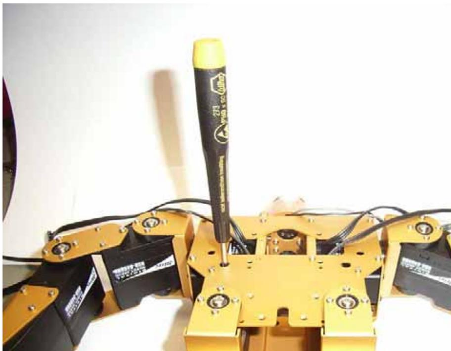
Dieser Schritt gelingt am einfachsten mit einem magnetischen Schraubendreher. Alternativ halten sie den Roboter mit der Rückseite nach unten und führen den Schraubendreher mit der Schraube von unten durch das Loch.
