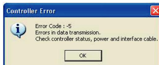
Abbildung 6: Fehler in Datenübertragung
