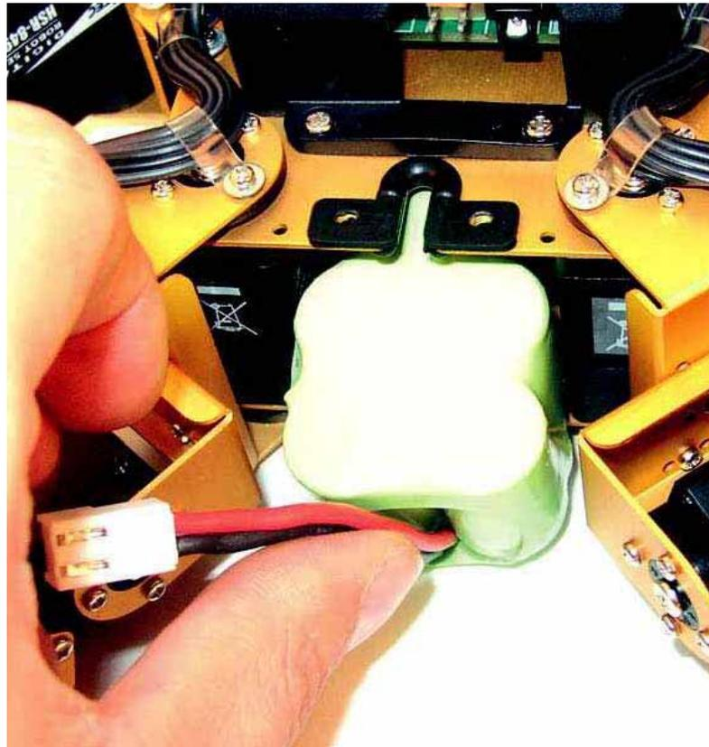
Hängen Sie das Körper Unterteil HR1B-0008 (130007) mit der Lasche in das Körper-Vorderteil ein und befestigen es mit den zwei Rändelschrauben M3 (132006).
